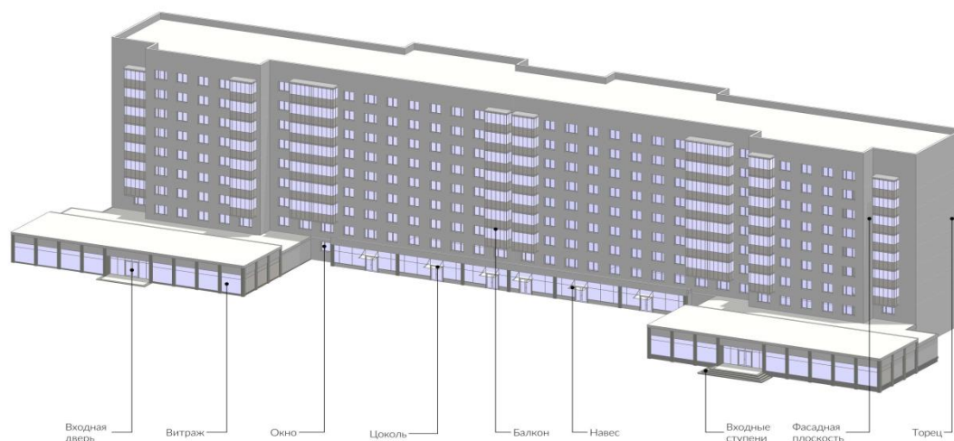
Рис. 2 Элементы фасада здания, являющегося многоквартирным домом со встроенно-пристроенными помещениями
