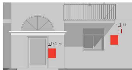
не соблюдаются расстояния от архитектурных элементов фасада до мемориальных табличек
